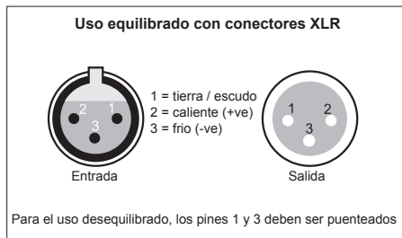
Fig. 4.1: Conexiones XLR
