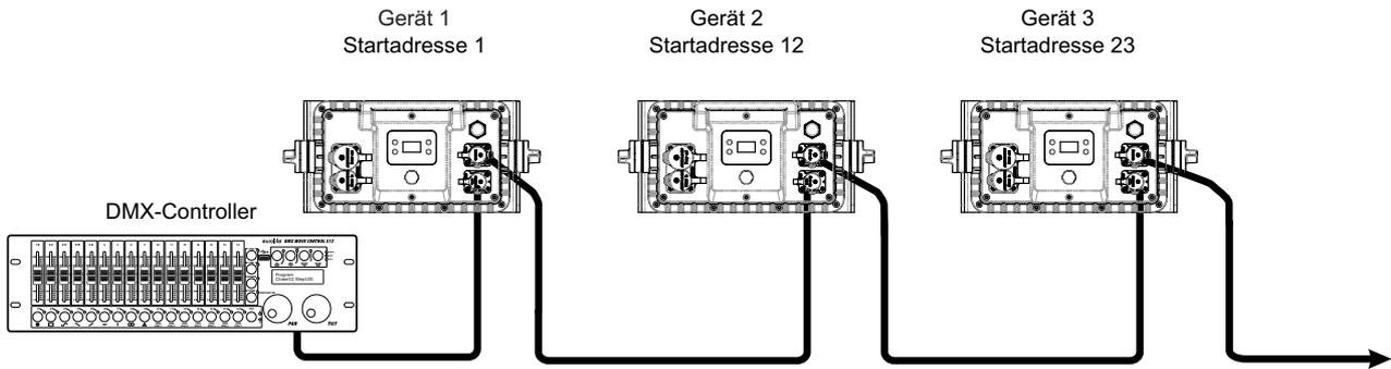
Für die Ansteuerung des Geräts per DMX512 ist eine Datenverbindung notwendig. Das Gerät verfügt dazu über spezielle DMX-Anschlüsse, die nach Schutzart IP65 ausgeführt sind. Passende DMX-Verbindungskabel sind optional erhältlich. Bei Nichtgebrauch die Anschlüsse unbedingt mit den Gummidichtkappen verschließen, um das Eindringen von Feuchtigkeit und Schmutz zu verhindern.
