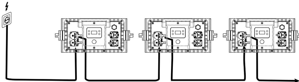
Das Gerät verfügt über ein Schaltnetzteil, das eine Netzspannung zwischen 100 und 240 Volt erlaubt. Die Netzanschlüsse sind nach Schutzart IP65 ausgeführt. Passende Verbindungskabel mit Spezialsteckern sind optional erhältlich. Bei Nichtgebrauch die Anschlüsse unbedingt mit den Gummidichtkappen verschließen, um das Eindringen von Feuchtigkeit und Schmutz zu verhindern.
